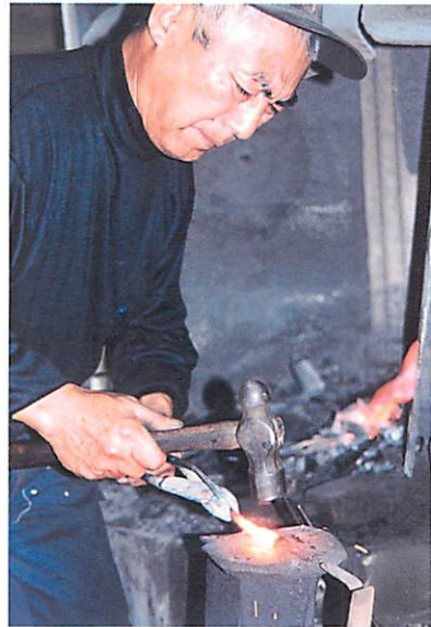
種子バサミを打つ（牧瀬刃物製作所） ©西之表市役所
